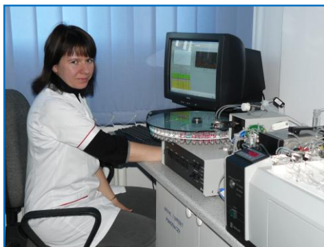
Na zdjęciu: Analiza azotu mineralnego w glebie z zastosowaniem spektrofotometru przepływowego.
